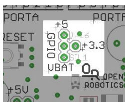
Рис. 5: Джемпер выбора питания портов
