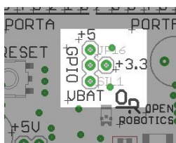
Рис. 5: Джемпер выбора питания портов
