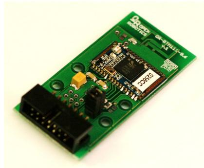
Bluetooth-адаптер OR-BTM111-9.6 предназначен для обеспечения связи между мобильным или стационарным роботом и любым головным Bluetooth-устройством (например, ПК, Ноутбук, КПК, сотовый телефон). Адаптер может выступать как головной контроллер или как подчиненный на шине RoboBus по интерфейсу UART.
