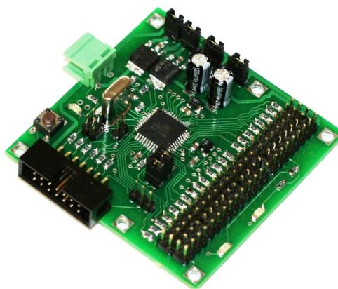
Контроллер общего назначения OR-AVR-M32-N предназначен для управления устройствами (сервоприводами, ИК-дальномерами, контактными бамперами и т.д.) мобильного или стационарного робота, может выступать как в качестве головного, так и в качестве вспомогательного контроллера.
